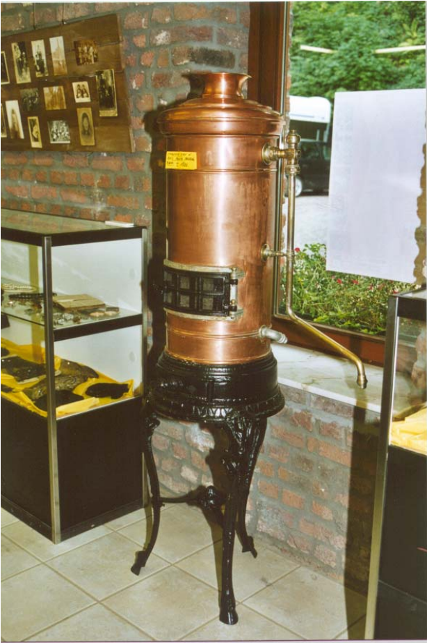
Chauffe eau à bois pour salle de bain.
