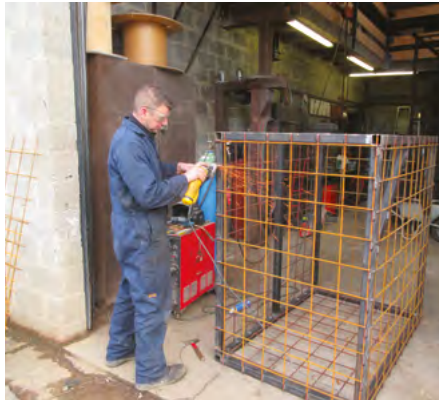
Construction d'un dispositif anti-obstruction
